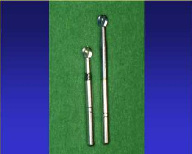
**Fig 9:** esempi di frese a rosetta in carburo di tungsteno
